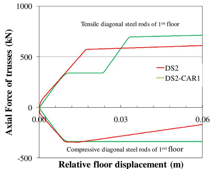
Figure 15. Axial forces of the diagonals steel rods of DS2 and DS2-CAR1
