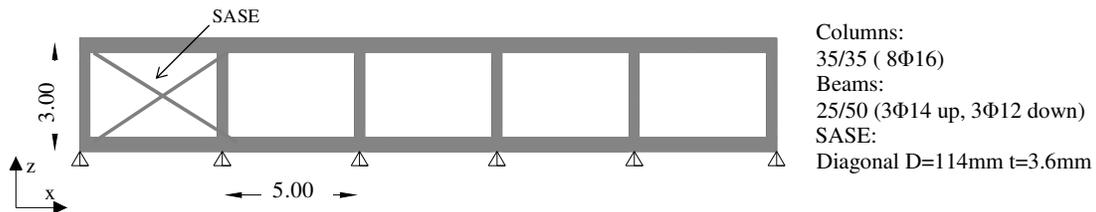
Figure 5. The one storey planar structural system DS1
