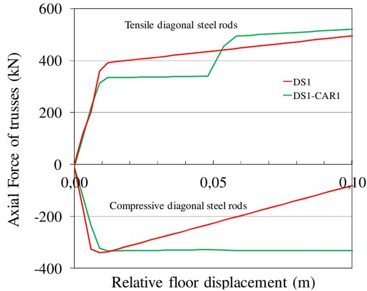
Figure 11. Axial forces of the diagonals steel rods of DS1 and DS1-CAR1
