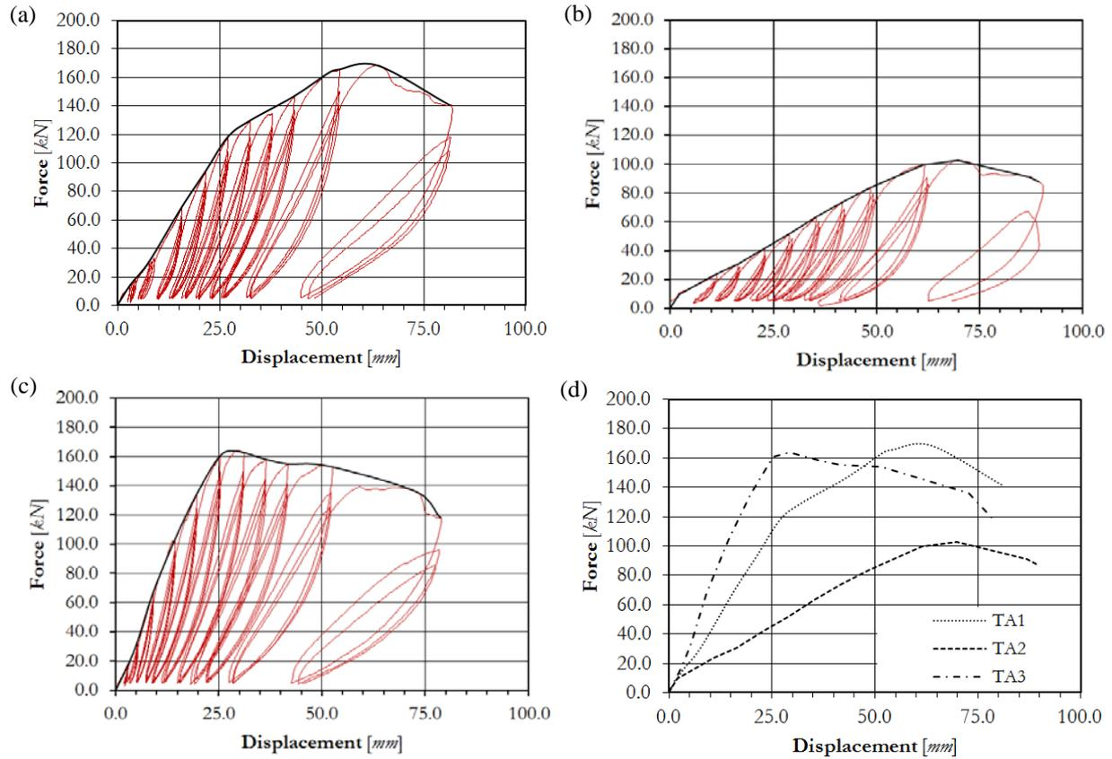
Figure 6. Force-displacement response: (a) TA1, (b) TA2, (c) TA3, (d) Comparison of TA1, TA2 & TA3
